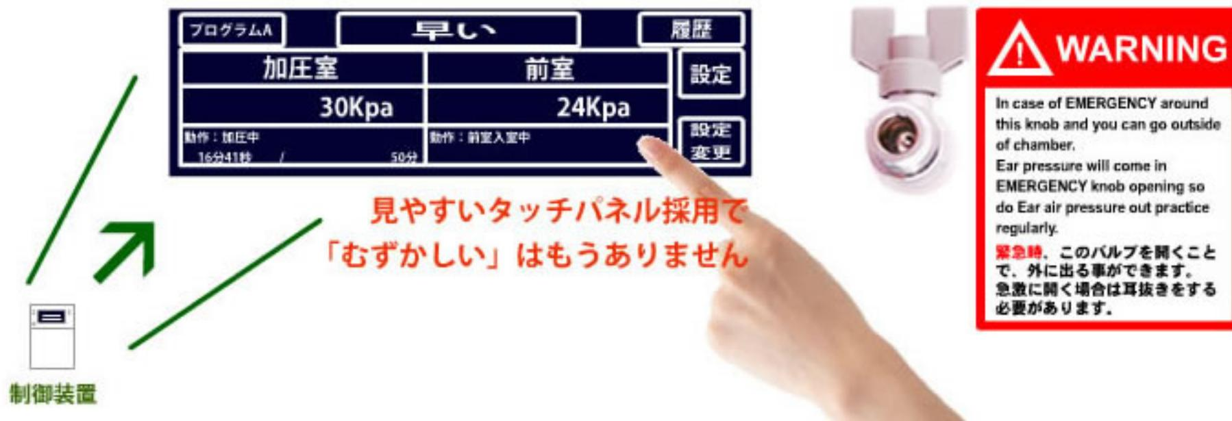
はじめてでも一人でかんたんに操作ができるように、新開発した制御コンピュータを搭載。加圧室と前室をそれぞれ独立して制御・モニターできる他に、あらかじめ時間をセットし、動作を停止するタイマー機能や、連続運転時間の設定、外部との連絡ができるモニター付きインターホン機能などを装備している他に、停電などによる不測の事態の際に緊急脱出を要する状況でも手動で脱出する事ができます。減圧～加圧は1.39気圧まで対応、ボタンを押すだけのかんたん設計で、本体部についている圧力弁でオーバー加圧にも対応します。通常の呼吸では不可能な量の酸素を体内に取り込む事が可能です。
